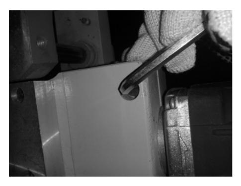
1.6 Аккуратно проворачивая привод по оси вращения извлечь его из корпуса редуктора
