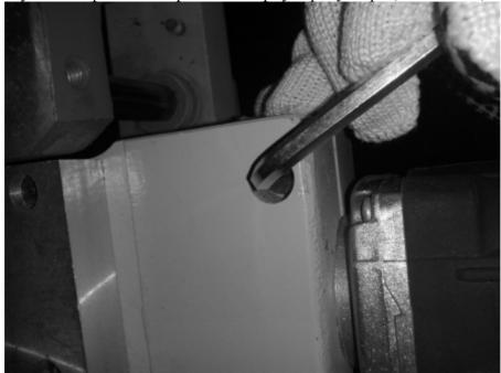
2.5 Затянуть гайку зажима цанги удерживая вал привода. !!! ПЛОХО ЗАТЯНУТАЯ ГАЙКА ПРИВЕДЕТ К ПРОСКАЛЬЗЫВАНИЮ ЦАНГИ И ПОВРЕЖДЕНИЮ ВЕДУЩЕГО ВАЛА РЕДУКТОРА !!!
