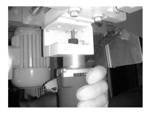
2.4 Затянуть винт фиксации привода в корпусе редуктора (ключ 5 мм)
