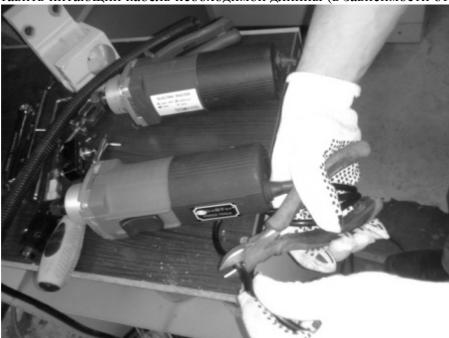
2.2 Зачистить концы и разделать изоляцию в месте установки концевого микровыключателя, разомкнуть одну жилу, оставляя вторую в изоляции.
