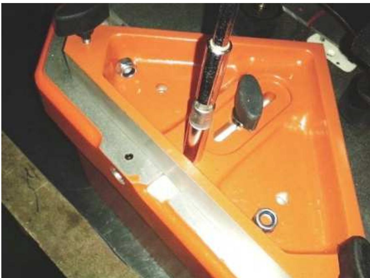
8. Добившись, таким образом, совмещения деталей сделать пробное соединение шпонкой. Если при этом детали не стыкуются вровень (как показано на рисунке ниже ) необходимо выполнить регулировку блока фрез.
