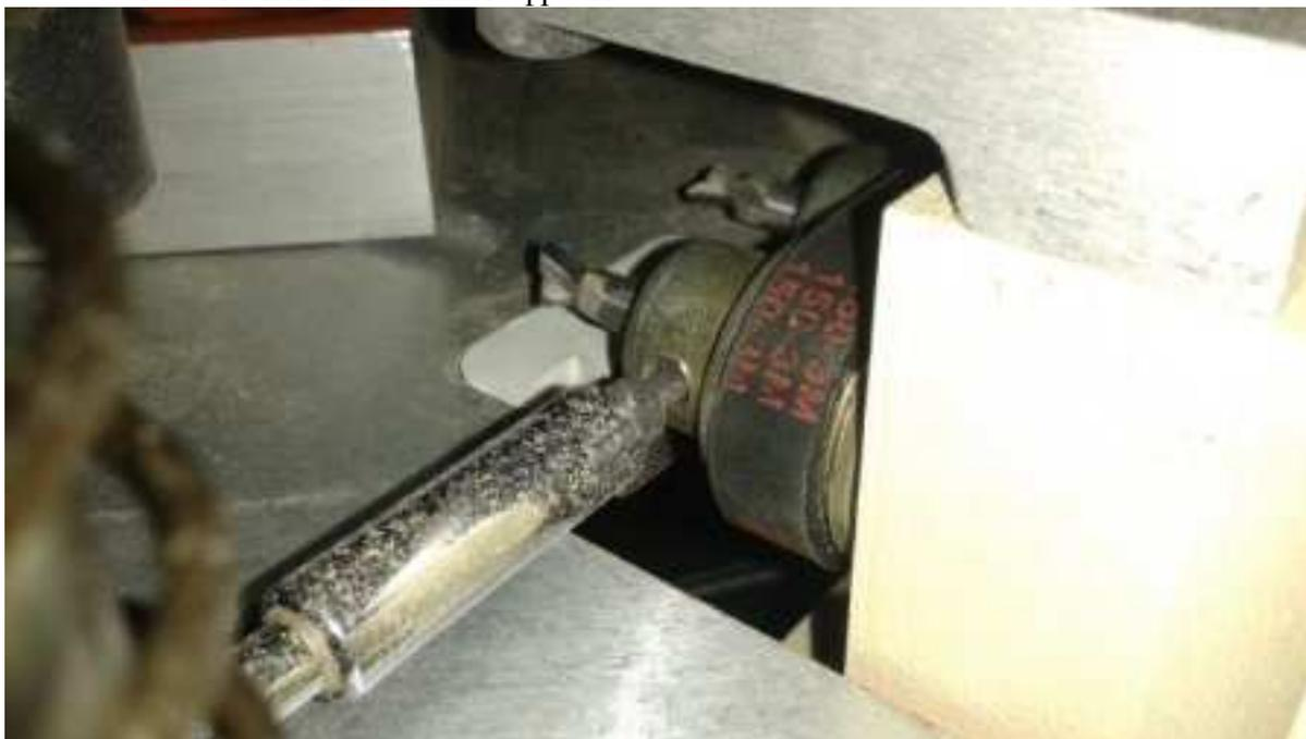
Аккуратно (НЕ ЗАХВАТЫВАТЬ ФРЕЗУ ЗА РАБОЧУЮ ЧАСТЬ ВО ИЗБЕЖАНИИ ЕЁ ПОВРЕЖДЕНИЯ ) сместить фрезу в валу( в данном случае утопить ) и зажать винт.
