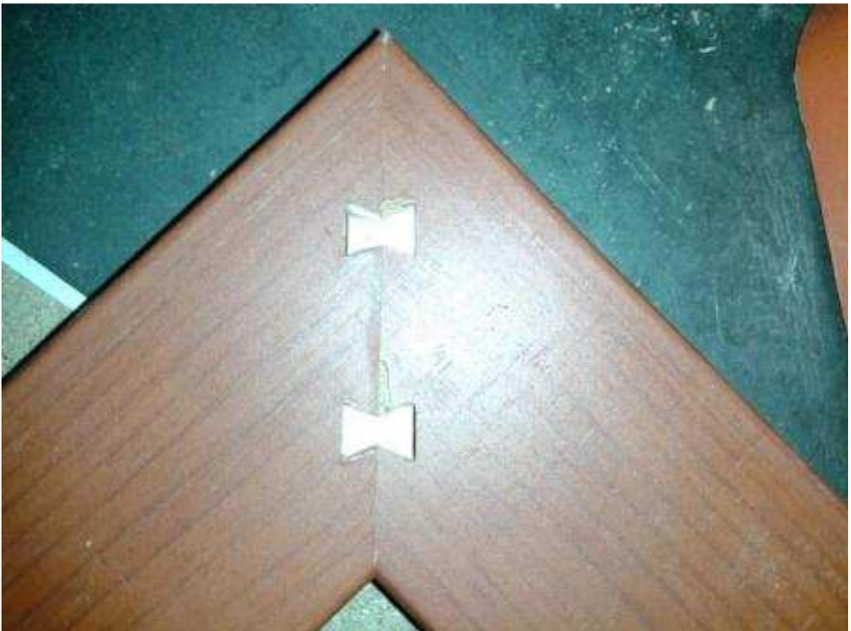
Как видно из рисунка детали совместились полностью, но образовались задиры пленки ПВХ, и стали заметны щели в пазах шпонки. Теперь следует произвести окончательную регулировку фрез по глубине (вылету), а площадку под фрезы (для предотвращения задиры пленки) следует менять после окончательной регулировки фрез.
